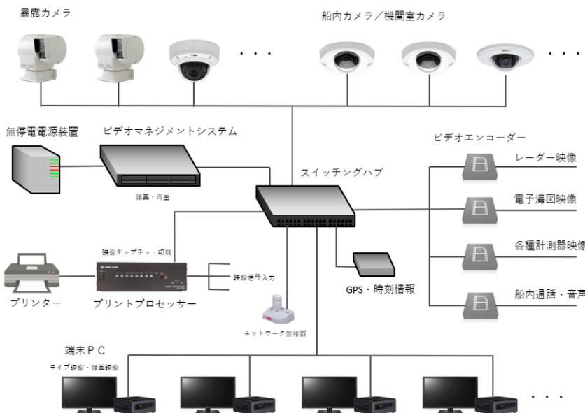
(1) カメラ映像と船内情報映像(電子海図、レーダー、各種計測機器映像など)をまとめてIPシステムで管理します。
