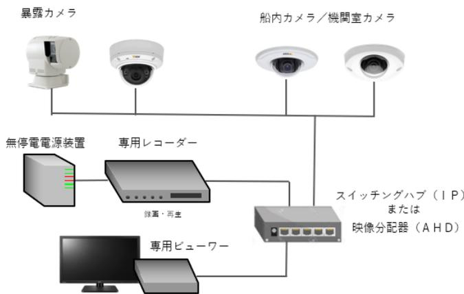
(1) 屋内用／屋外用、固定／PTZ、赤外線カメラ、音声入力など様々なタイプのカメラに対応します。
